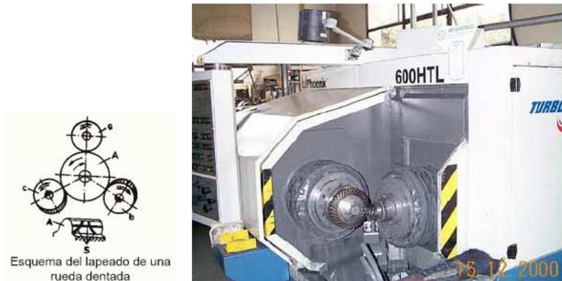
*Figura 3.30. Proceso de lapeado de un engrane*
