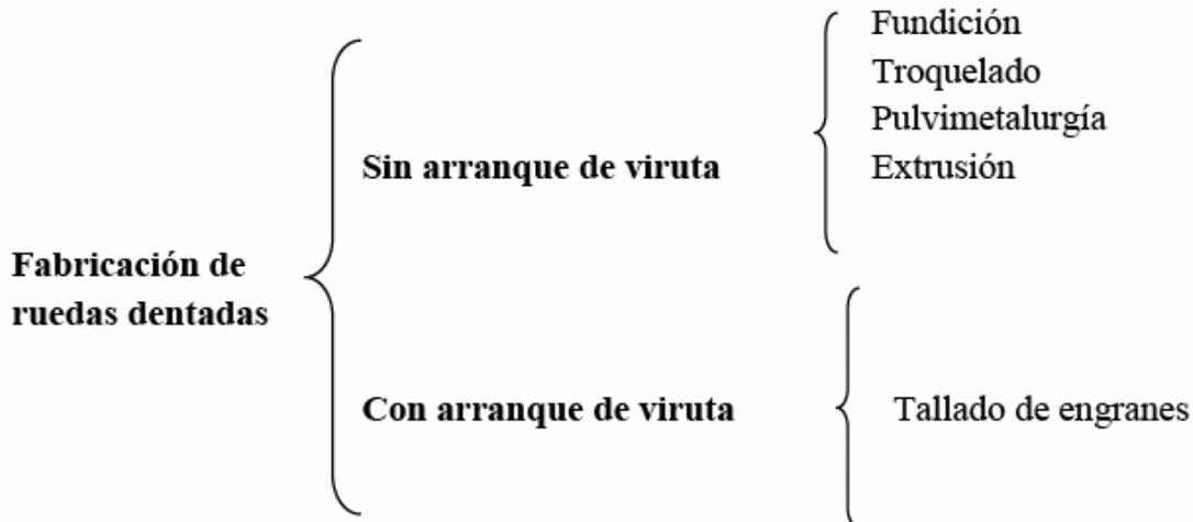
*Figura 3.2. Clasificación de los métodos para fabricar engranes*
