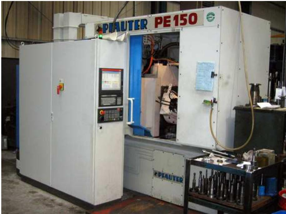
*Figura 1.41. Fresadora CNC para la fabricación de engranes con fresa madre.*
