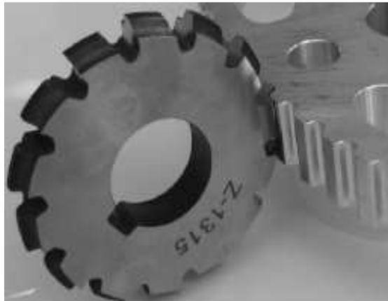
*Figura 3.11. Tallado de un engranaje con fresa de módulo*
