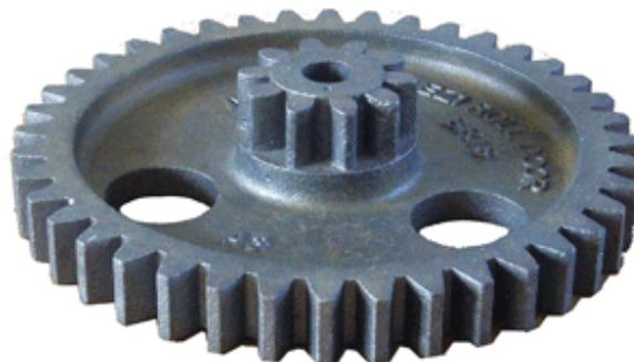
*Figura 3.3. Engrane obtenido mediante fundición.*
