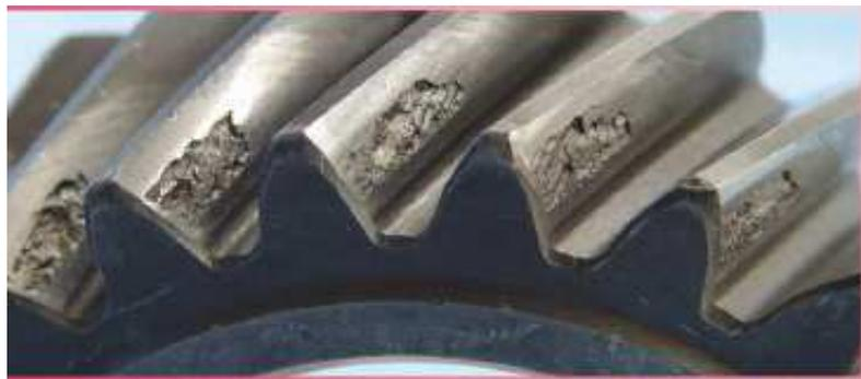
*Figura 4.13. Desconchado de un diente de engrane*
