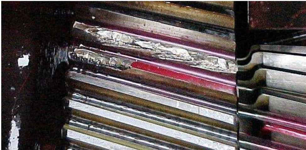
*Figura 4.20. Falla combinada en un engrane.*
