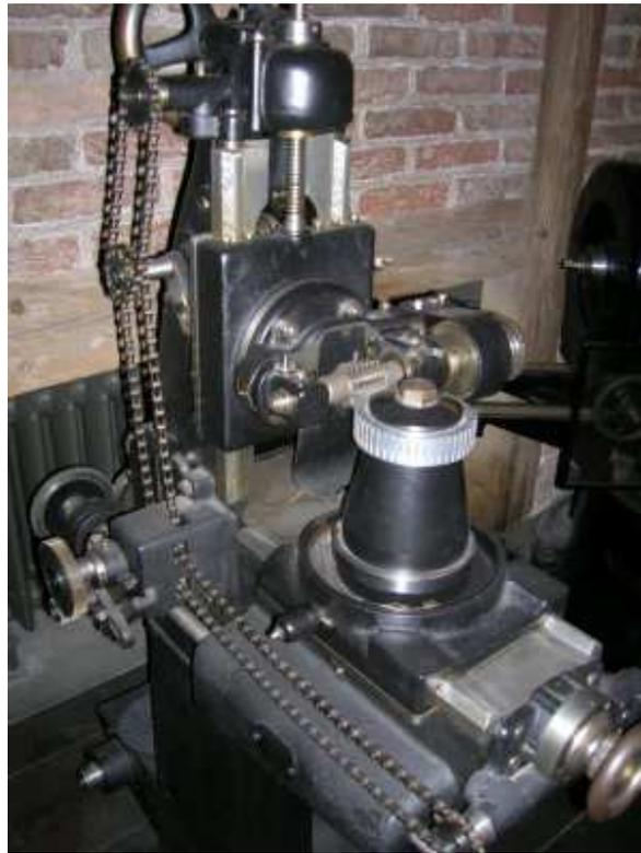
*Figura 1.26. Máquina desarrollada por Robert Hermann Pfauter para la fabricación de engranes mediante fresa madre.*
