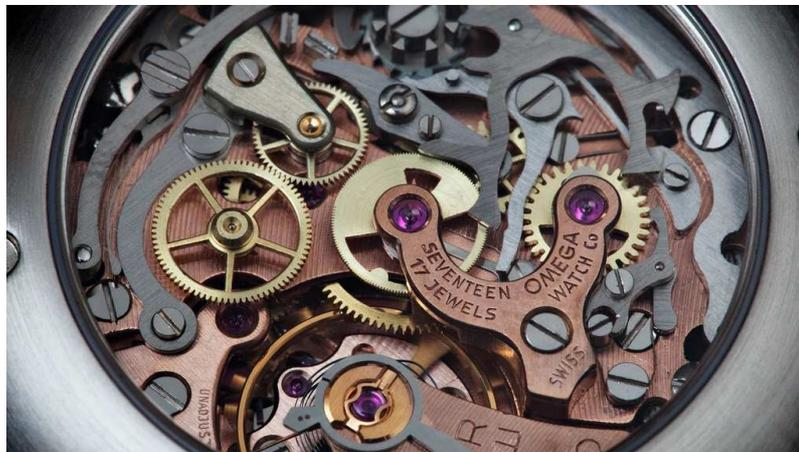
*Figura 3.1. Mecanismo mediante engranes en un reloj de pulso moderno.*
