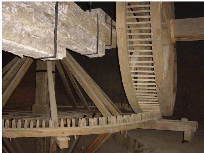
*Figura 2.1. Engranes primitivos de madera*
