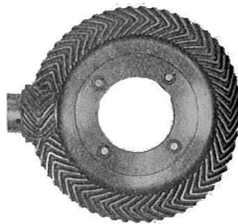
*Figura 1.24. Mecanismo piñón –corona con engranes chevrón o doble helicoidales.*
