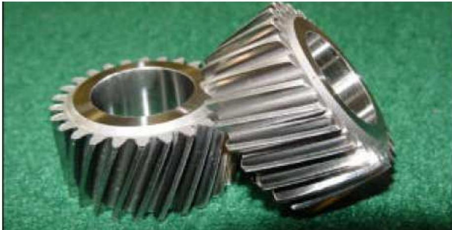
*Figura 3.5. Engranés helicoidales obtenidos mediante pulvimetalurgia con un ángulo de hélice de 22°.*
