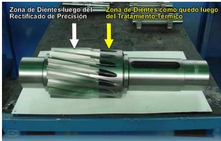
*Figura 3.28. Eliminación de la distorsión generada mediante el tratamiento térmico mediante rectificado*
