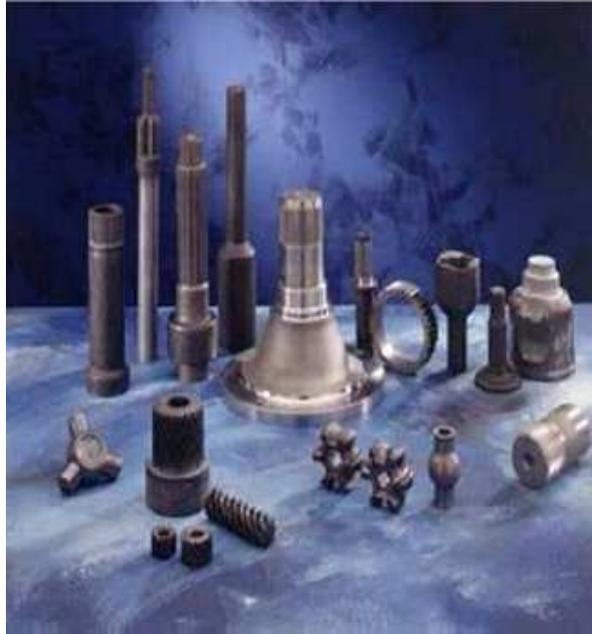
*Figura 3.7. Piezas mecánicas obtenidas mediante extrusión.*
