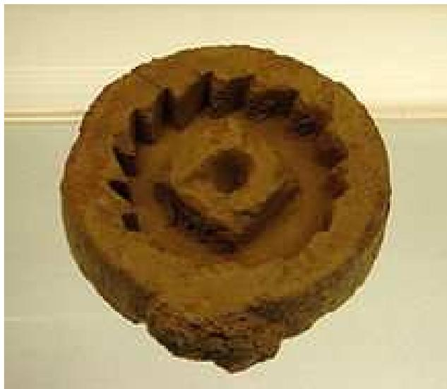
*Figura 1.2. Molde chino para fabricar engranajes de bronce (siglos II a. C. a III d. C.).*
