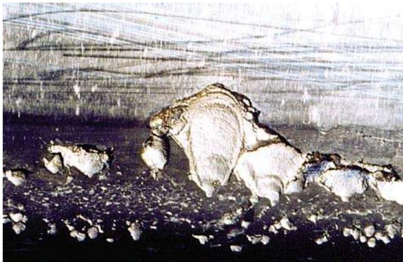
***Figura 4.7. Falla por picado en la superficie de contacto de un diente de engrane. Las “marcas de playa” son visibles en algunos de los agujeros grandes.***
