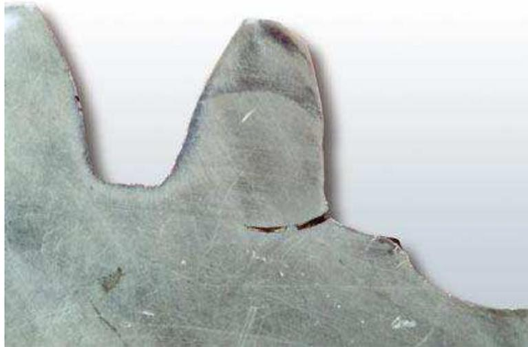
*Figura 4.16. Inicio de la falla en la raíz del diente*
